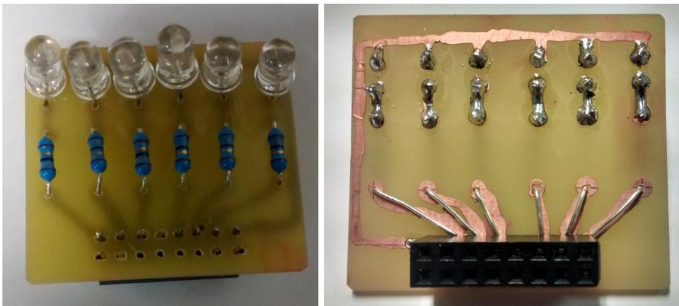
Figura 8: Vista del reverso de la placa, con los puntos de soldadura
