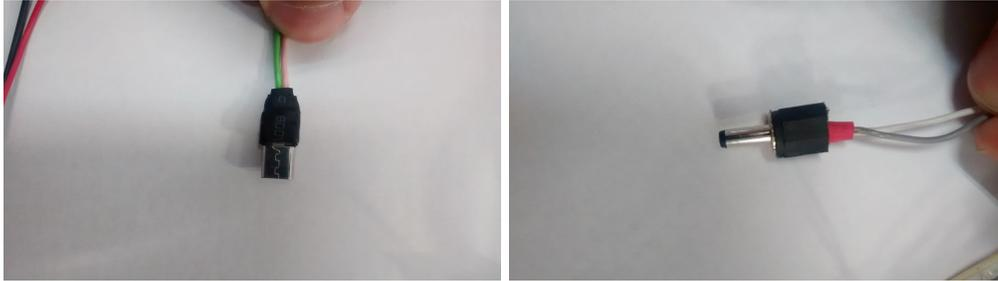
Figura 5: Conectores USB y DC creados modificados
